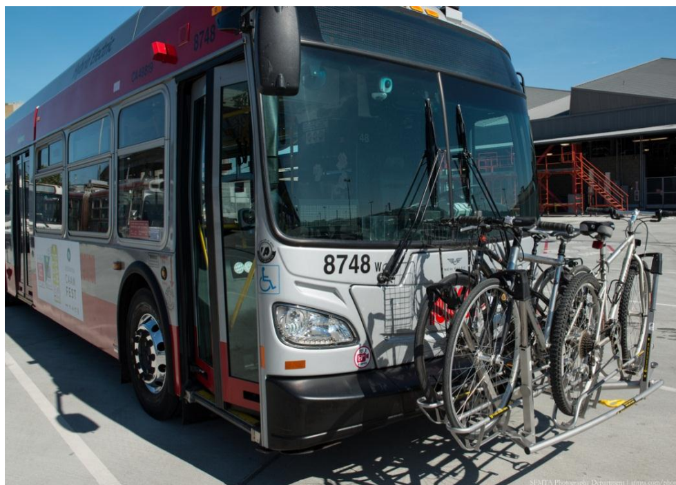
شکل ۲۰- نمونه‌ای از نصب دوچرخه‌بر در جلوی اتوبوس
